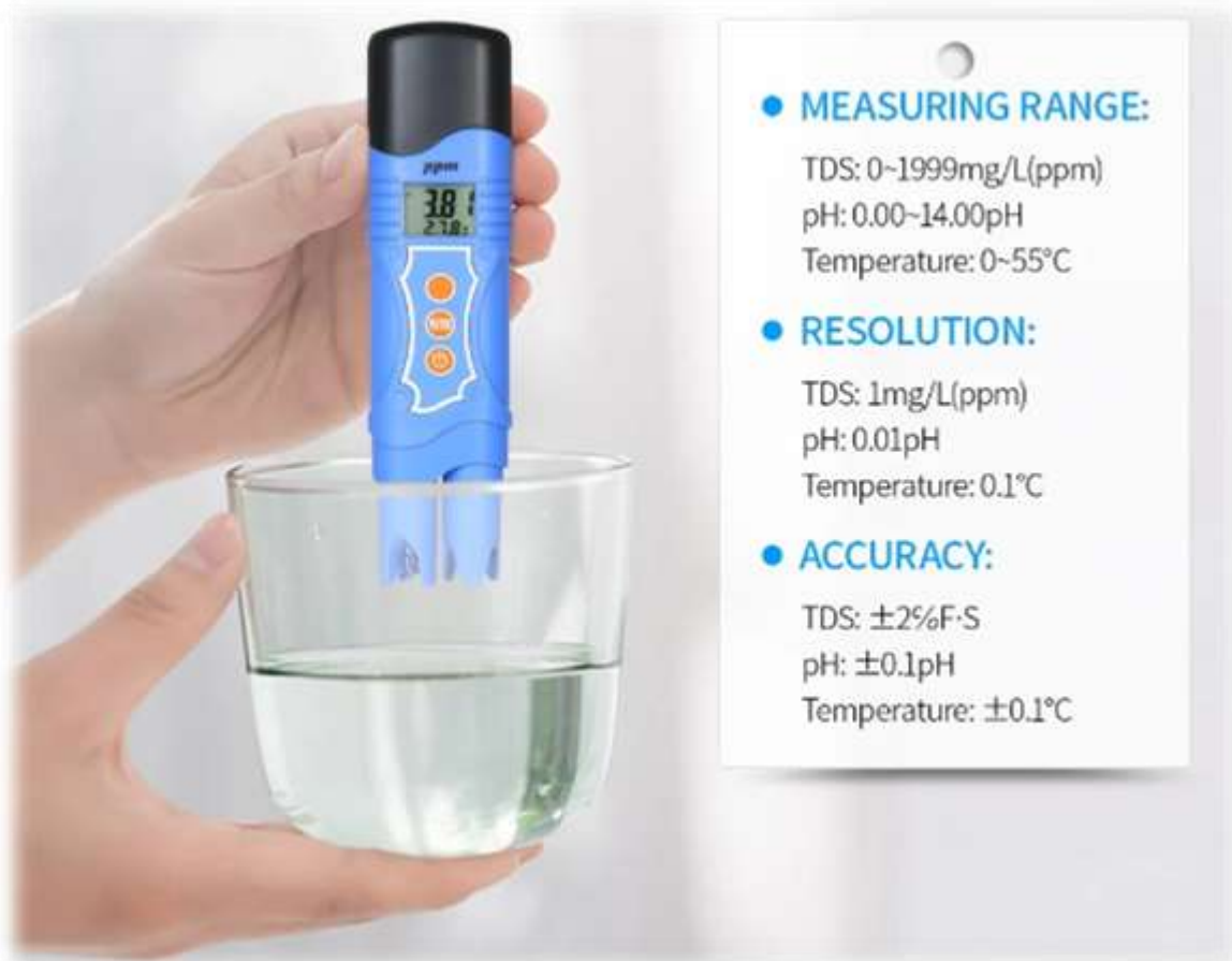
Mittelpreisiges TDS / pH / Temperaturmessgerät, kosten so ca. 40 EUR bei Amazon
